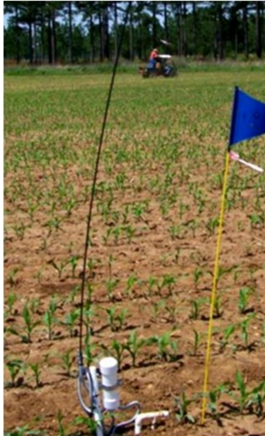
Εικόνα 13: Αισθητήρας υγρασίας εδάφους σε βαμβάκι[38]
