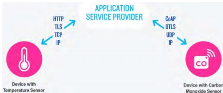
Εικόνα 4: Παράδειγμα μοντέλου επικοινωνίας Device – to – Cloud [20]
