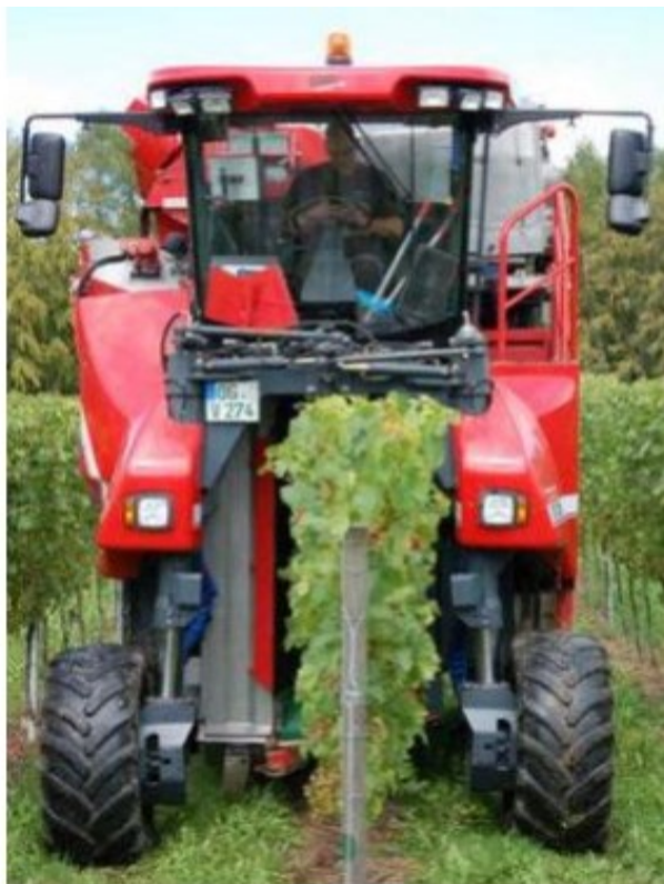
Εικόνα 9: Σύστημα αυτοματισμού για συγκομιδή σταφυλιών [33]
