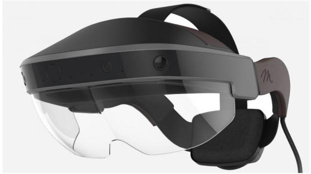
**Εικόνα 1.4** Συσκευή τύπου Helmet Mounted Display.
