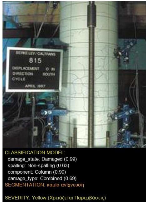
Εικόνα 25. Οριακή περίπτωση: μηδενικές ανιχνεύσεις segmentation παρά damage_type=Combined.
