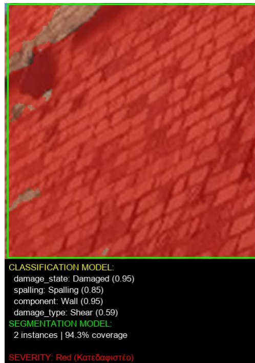
Εικόνα 20. Extensive→Red: Wall, Shear, κάλυψη 94,3%.
