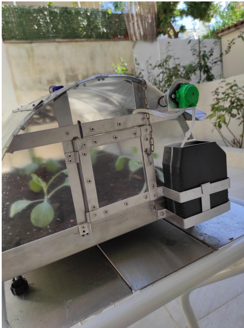
Εικόνα 11 – Αντλία νερού και ντεπόζιτο αποθήκευσης νερού
