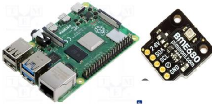
Εικόνα 2 Raspberry Pi & BME 680
