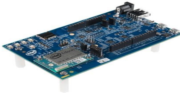
Εικόνα 4.6 Η πλακέτα Intel Edison
