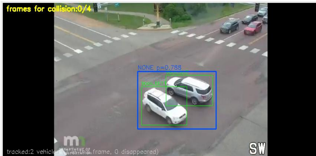
Εικόνα 35: Frame από την δοκιμή του συστήματος. Διαφορετική περίπτωση αυτοκινήτων που προσεγγίζονται μεταξύ τους, αλλά το σύστημα δεν βρίσκει σύγκρουση
